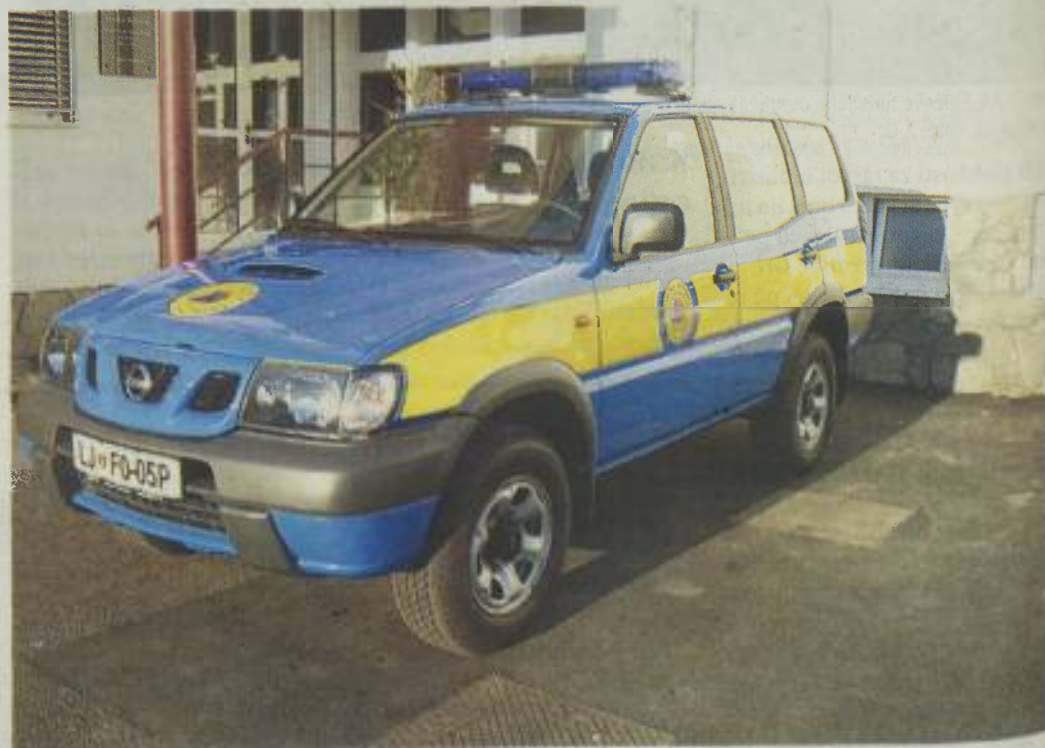
Vozilo Nissan Terrano II 2.7 6+1 je specialno vozilo za delo štaba oz. štabno terensko vozilo. Uporablja ga štab Civilne zaščite za Pomurje. V primeru naravnih in drugih nesreč ga lahko opremijo z vso opremo, ki omogoča delovanje štaba na terenu.
