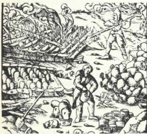
Sl. 1. Pridobivanje živega srebra z retortno metodo v 16. stoletju (Agricola, De re metallica, 1557).
