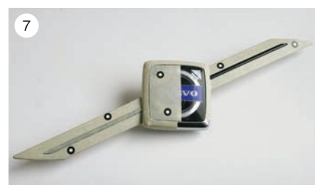
Polepljen znak je nared za digitalizacijo. Maskirni trak smo pozneje odstranili brez težav [1].
