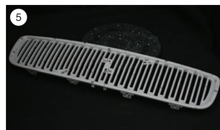
Prebarvana avtomobilska maska z nameščenimi referenčnimi točkami je pripravljena na digitalizacijo [1].
