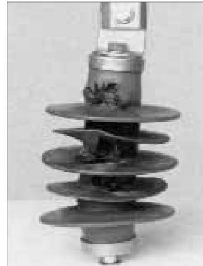
Slika 4: Prenapetostni odvodnik, ki ga je poškodovala strela in tako povzročila kratek stik.
