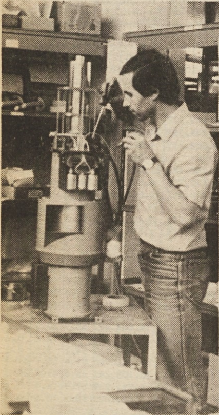
Montaža 10-kilovattnega resonatorja za televizijski oddajnik Siemens.
