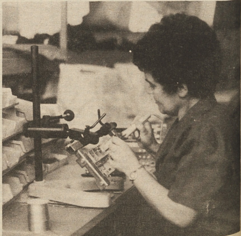
Montaža nizkonapetostnih stikal v tozdu Ten-Energetika.
