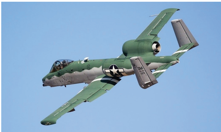
Pogled na letalo A-10C v zraku, ki ga upodablja Revellova maketa, na katerem so vidni dodatni senzorji na koncih kril in repnih površinah ter antenski sistem na hrbtu letala.
