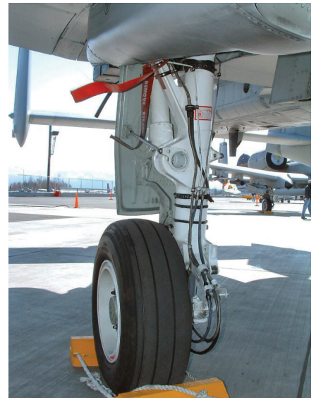
Eno od koles pod krilom, kjer je dobro viden razvod hidravličnih cevi, ki jih je treba ponazoriti na maketi. Po zadnjih dograditvah so notranje kolesne prostore in noge podvozja v glavnem barvali z belo barvo, ki je nadomestila ADC sivo (FS16473).
