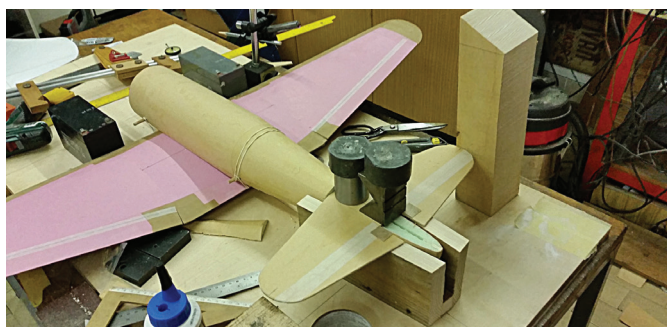
Pritrjevanje višinskega stabilizatorja
