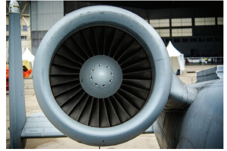
Vstopnik zraka na motorju s prvim nizom lopatic, ki ima 28 členov in ne 32, kot so jih upodobili na plastičnih sestavnih delih. Problem rešuje QB72411.
