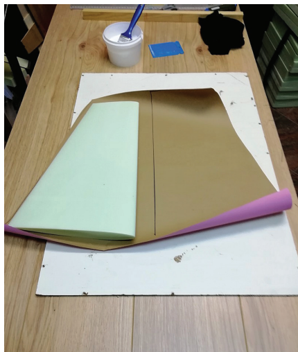
Del krila pred lepljenjem položimo na grobo prirezan papir
