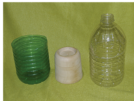
Trilitrska plastenka in kalup za izdelavo pokrova motorja
