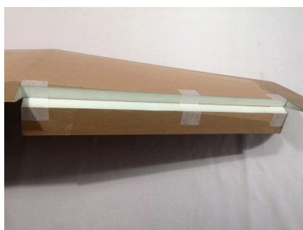
Izrez krilca in utrjevanje z micropor trakom
