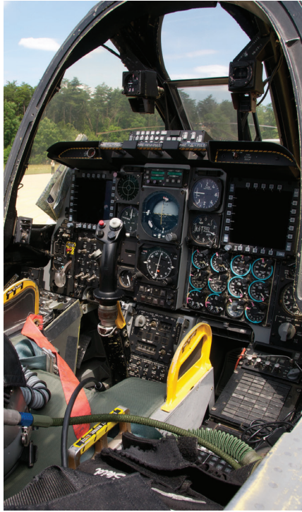
Posodobljena instrumentna plošča A-10C z dvema večjima prikazovalnikoma podatkov in spremenjenim okrovom instrumentne plošče
