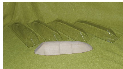
Zasteklitve kabin, izdelane na vakuumiranjem stroju.
