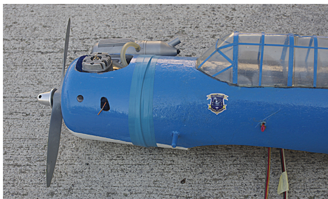
Izrezi in montaža pokrova motorja
