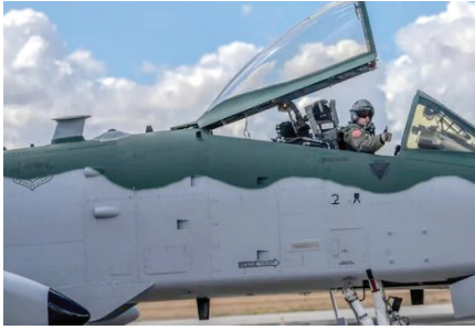
Desni bok A.10C z vidno anteno AN/ARC-210 BLOS in izbočeno kupolo GPS navigacijskega sistema, ki ju je na maketi treba izdelati v samogradnji.
