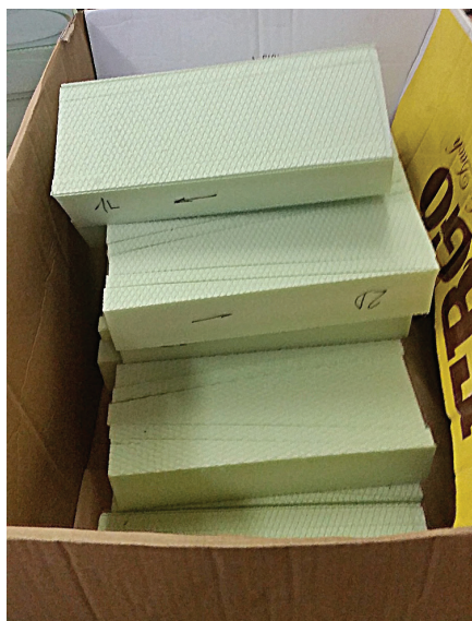
Izrezan stirodur za izdelavo trupov
