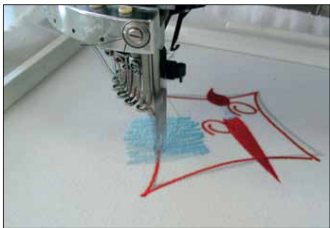
Slika 5. Design med izdelavo. Vidimo lahko več igel z različnimi barvami niti, ki se med vezenjem zamenjujejo. V zgornjem delu slike se vidi kljuka, ki po odrezu odmakne konec niti od vezenja.
