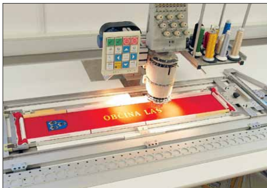
Slika 12. Stroj za vezenje med redno produkcijo. Izdelek v izdelavi ima 35.000 vbodov, 9 barv, čas izdelave je okoli 50 min.
