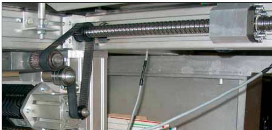
Slika 9. Pogon osi Y po vgradnji navojnega vretena
