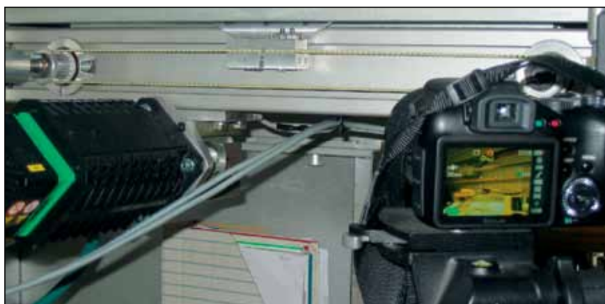
Slika 8. Snemanje nihanj zobatega jermena osi X s hitro kamero Casio EX-F1. Kamera lahko snema s hitrostjo do 1200 posnetkov v sek.
