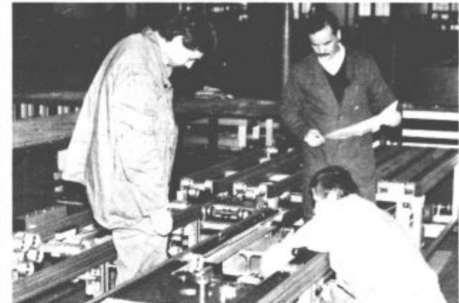
Delavci Vzdrževanja Gorenja Gospodinjski aparati so izdelali taktno sklopljene transporterje in dvizne ter obračalne mize za posodobitev obrata Zamrzovalne skrinje
