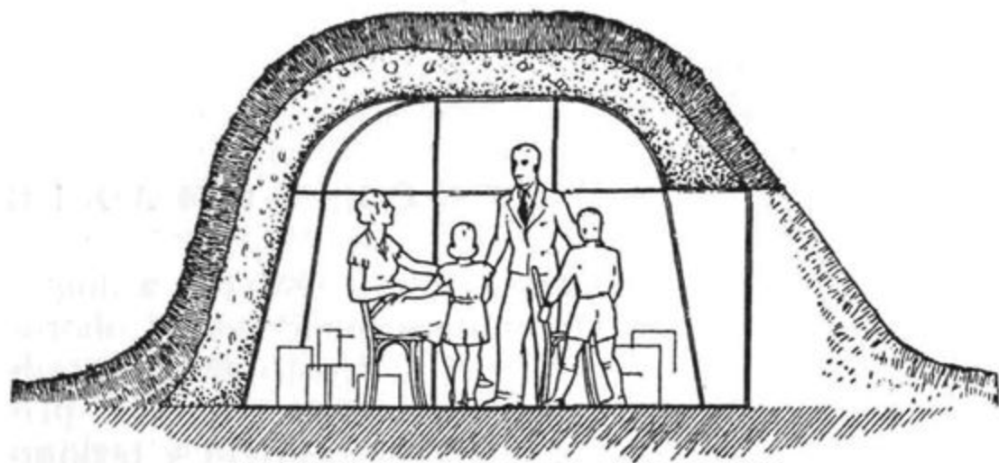
Družinsko zavetišče na vrtu iz pločevine, ki je obdana z betonom, zemljo in rušami
