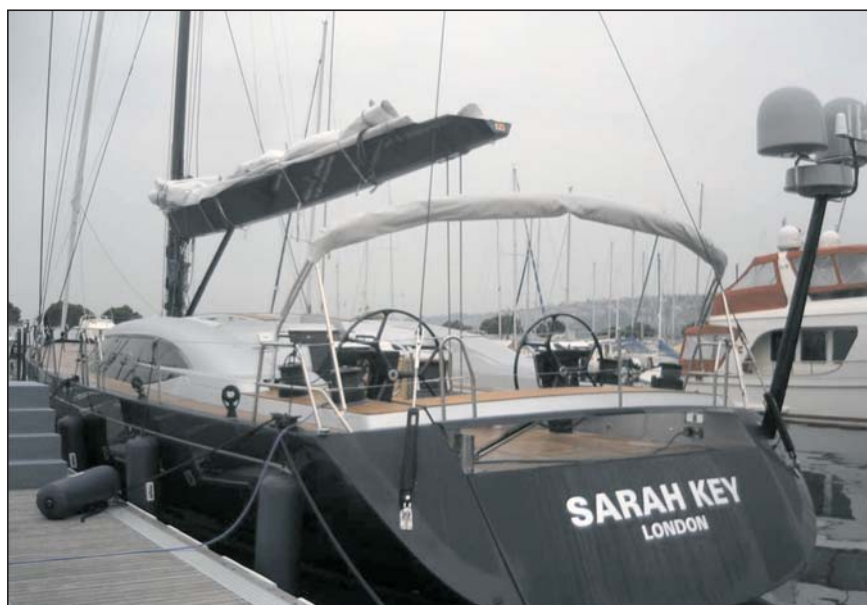
Slika 1. Jadrnica Shipman 72 – Seaway, ki je v vrhu tovrstne tehnologije in vsebuje: sistem sidra, sistem bočnega pogona, navijalna vitla, dvizžno kobilico z blokirnim sistemom, mostiček za prehod na kopno – pasarela, kopalno ploščad, cilindre za trimanje, centralni hidravlični tristopenjski agregat kot vir hidravlične energije, hidravlične ventile in napeljavo za prenos energije in krmiljenje sistemov.
