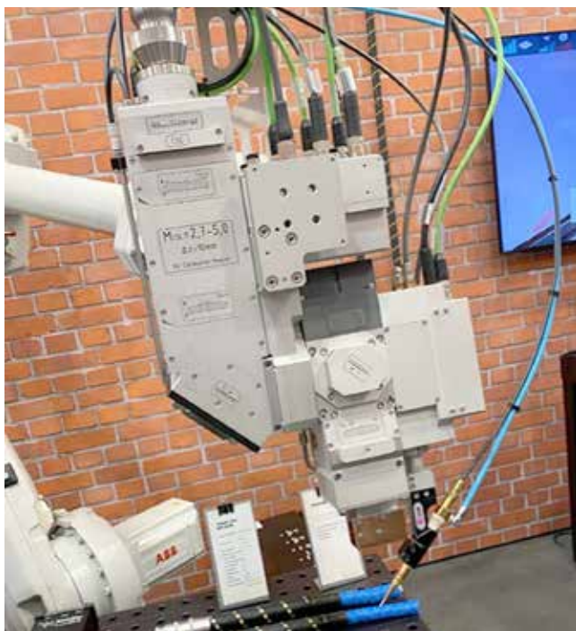
Slika 1: Varilna glava za varjenje z laserskim žarkom in z dodatnim materialom
