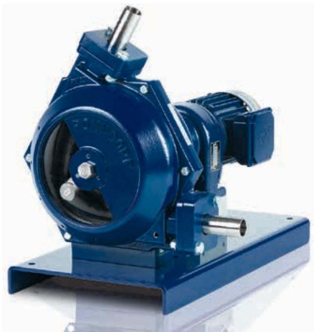
Slika 1: Cevna črpalka Ponndorf P_classicplus – pretok do 5.500 l/min in delovni tlak do 4 bar
