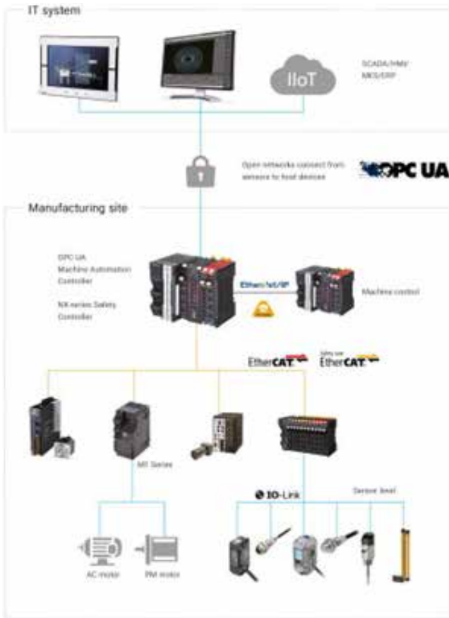
Slika 3 : Topologija povezave IT in proizvodnega nivoja za zagotavljanje trajnostne proizvodnje
