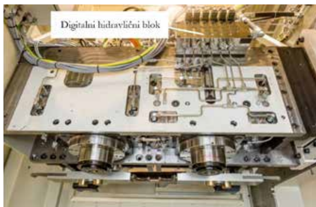
Slika 1 : Mikropozicioniranje sistema z digitalnimi ventili [5]
