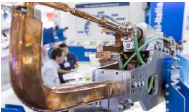
Slika 4 : Varilne klešče za uporovno varjenje večjih varjencev
