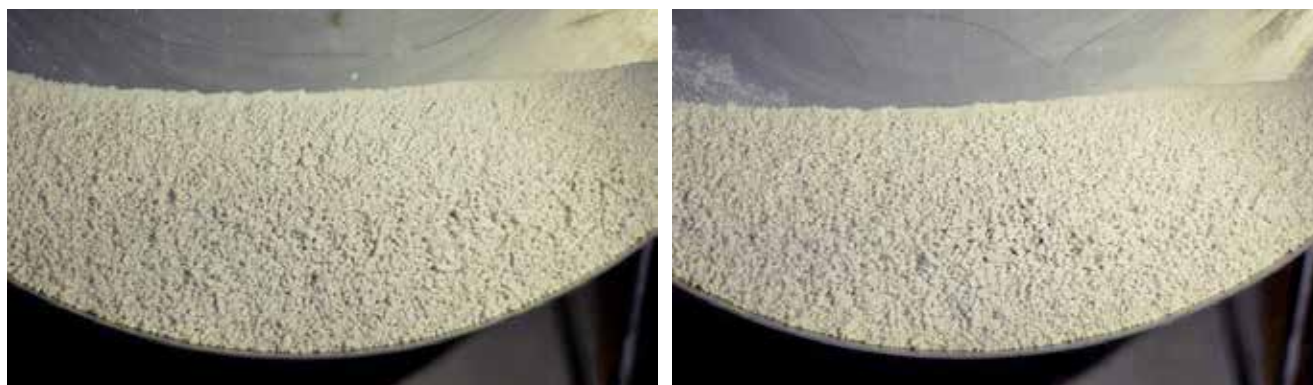
Slika 5 : Stanje granuliranja kombinacije VM + G pri časih 15 s (a) in 30 s (b)
