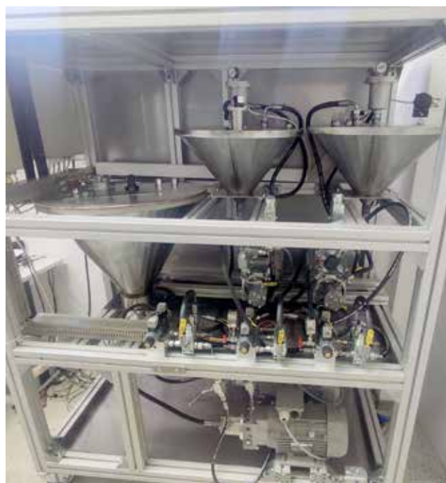
Slika 2 : Trojno trajnostno preizkuševališče za testiranje zobniških črpalk pri različnih čistočah in različnih delcih [10]
