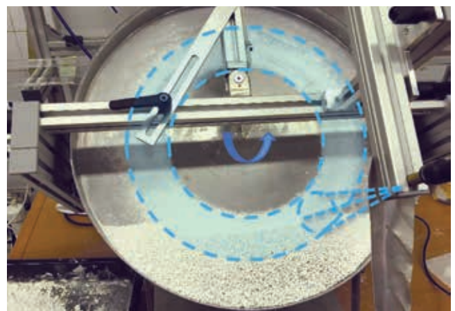
Slika 7 : Granuliranje pri kombinaciji VM + A s pršenjem vode
