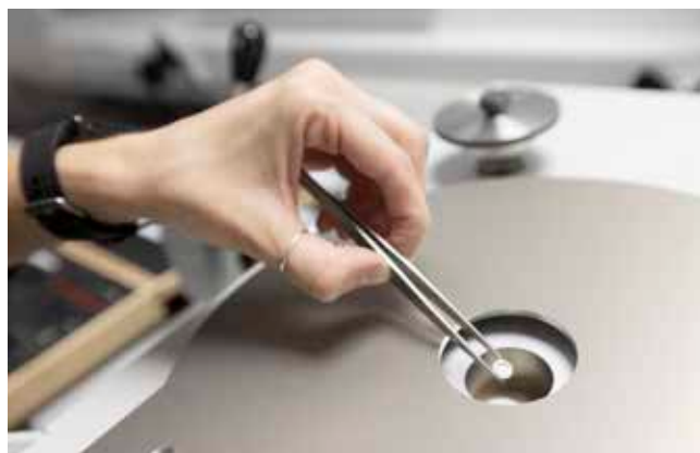
Slika 2 : Sistem za termično karakterizacijo multifunkcionalnih energijskih materialov (Foto: IFP, d. o. o.)
