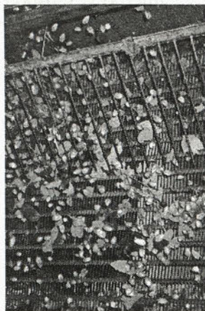
Foto: M. Veronek Da se listje in vejice prilepijo na mrežo II. zračnega čistilnika, ker so težje od storžkov in imajo manjšo površino, jih je treba približati na mehanski način. Ob zmanjšanem pretoku zraka, ni nevarnosti, da bi med odpadke uhajali tudi storžki hmelja. Čiščenje je bolj selektivno.
