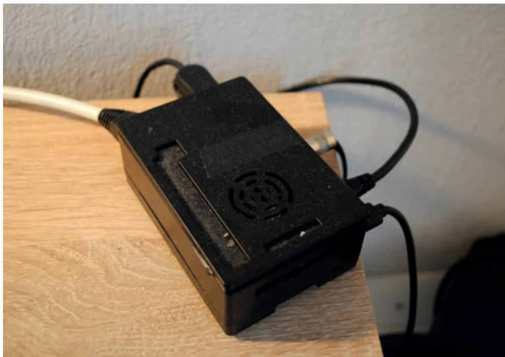
△ Kot kolesarski računalnik z lastnim zaslonom ali brez lahko uporabimo tudi raspberry pi, ki mu dodamo ustrezna tipala in ga napajamo iz 5-voltnega polnilnega baterijskega modula.
