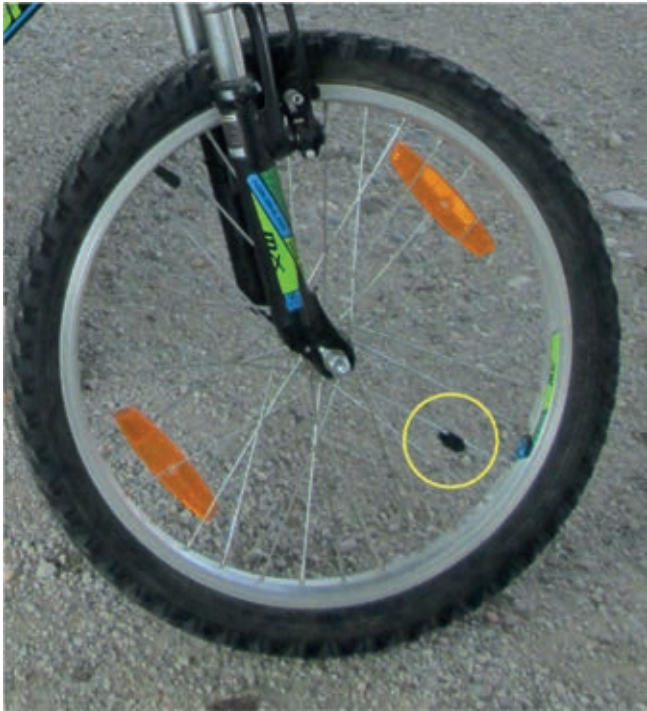
△ Prednje kolo z magnetom, ki proži tipalo za merjenje obratov, pritrjeno na prednje vilice.
