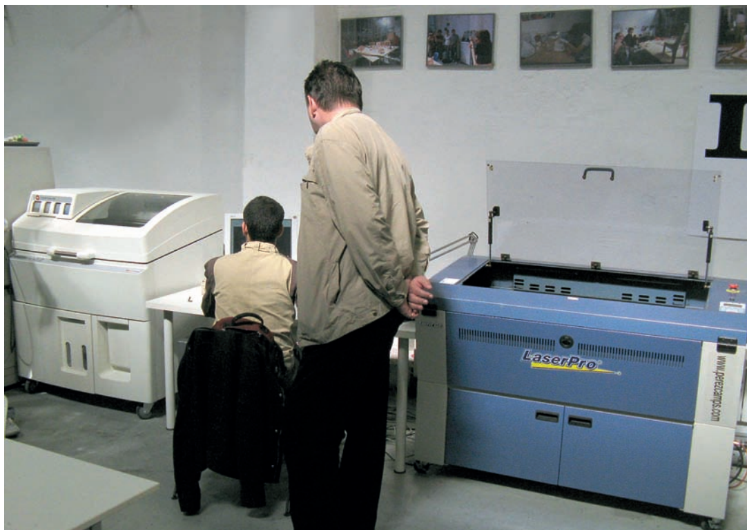
Laboratorij za praktično usposabljanje 3D-tiskanja v inštitutu laac. Slika zgoraj prikazuje tridimenzionalne izdelke, ki so jih natisnili s tiskalnikom na levi strani spodnje slike. »Klišegraf« LaserPro gravira ali reže zelene strukture na navaden papir.
