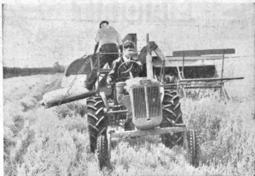
To je najnovejši hitrostni traktor, ki je kombiniran z žetvenim strojem, ki ga imenujejo »Splošni britanski kombiniran žetveni stroj«. Zadnja stran je razširjena v veliko krmilo, ki ima več prestav za jakost, ki se lahko poljubno regulira. Te traktorje izdelujejo v velikih količinah ter jih bodo že do konec leta začeli izvažati številnim državam
