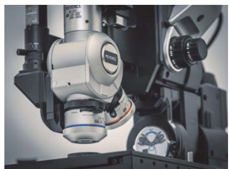
Motorizirana mizica, velikosti 100 x 100 mm omogoča preiskavo sorazmerno velikega vzorca. Foto: Borut Žigon
