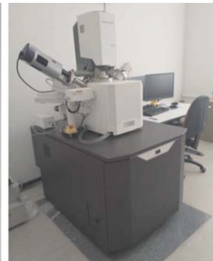
FEG SEM Thermo Fisher Scientific Quattro S instaliran v Laboratoriju za mikroskopijo, Katedre za inženirske materiale, Oddelka za materiale in metalurgijo, Naravoslovnotehniške fakultete Univerze v Ljubljani.
