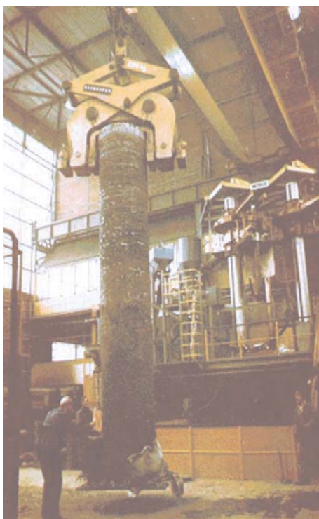
EPŽ ingot \phi 1000 x 6240 mm pretaljen leta 1982 v Železarni Ravne
