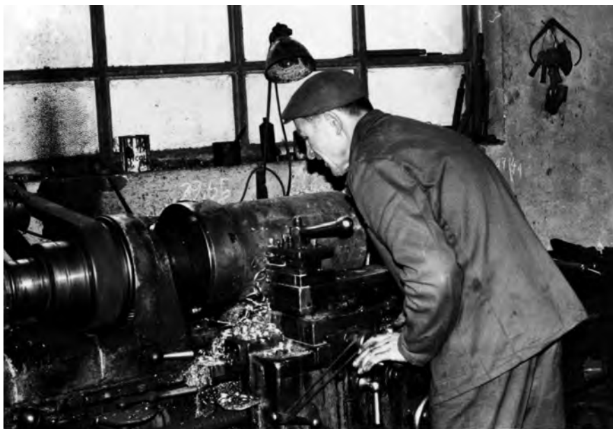
163. Tone Kunc reže cevi za zavorni boben na stružnici.
