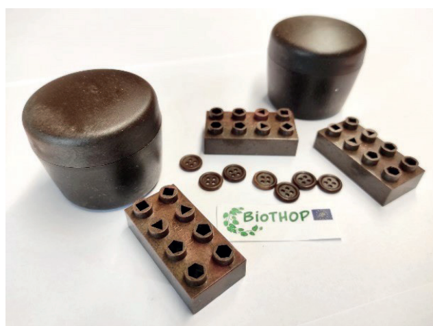
Izdelki, narejeni na osnovi biokompozita z 20 % vsebnostjo hmeljevih vlaken iz Savinjske doline (Foto: J. Polanšek)
