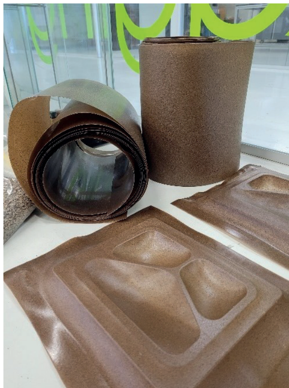
Zvitki iz litega ekstrudiranega materiala in termoformirani pladnji za avtodome, izdelani iz vlaken hmeljevine (Foto: I. Serrano)
