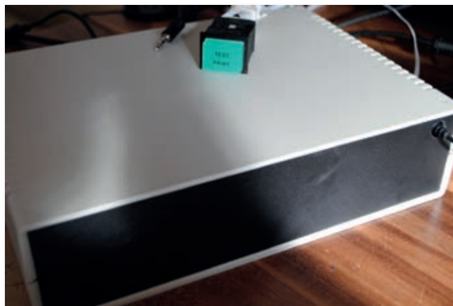
△ Raspberry Pi 5 kot namizni računalnik v nekoliko večjem ohišju, v katerem je prostor tudi za večino dodatkov. Tipke za vklop namenoma nisem vgradil, da lahko računalnik postavim pod mizo.
