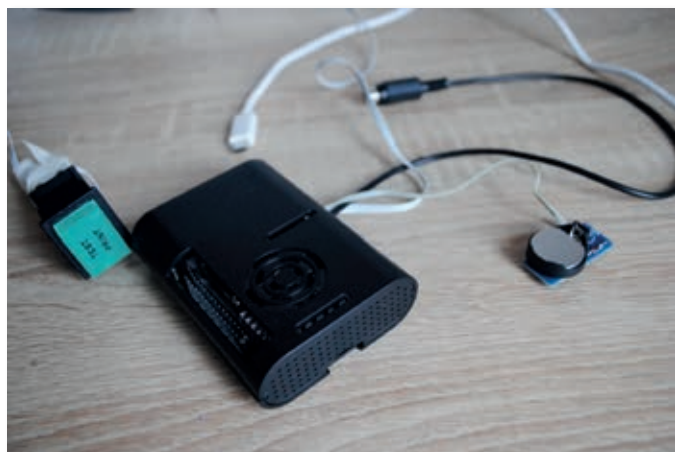
△ Doma narejena baterija za pogon ure realnega časa med odklopom napajanja in zunanja tipka za mehki vklop ter izklop.
