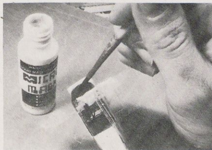
Večkratni nanos maskirne emulzije bo zaščitil prozorne površine. Za lažje delo lahko v Micro Mask kanemo tudi kapljico tempera barve.
