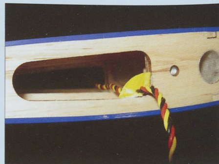
Servokabel sem na krilo pritrdil s pomočjo tankega laminata in sekundnega lepila.
