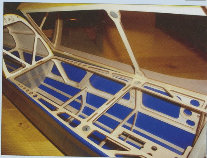
Kabina se zapira s pomočjo magnetov in zapirala.
