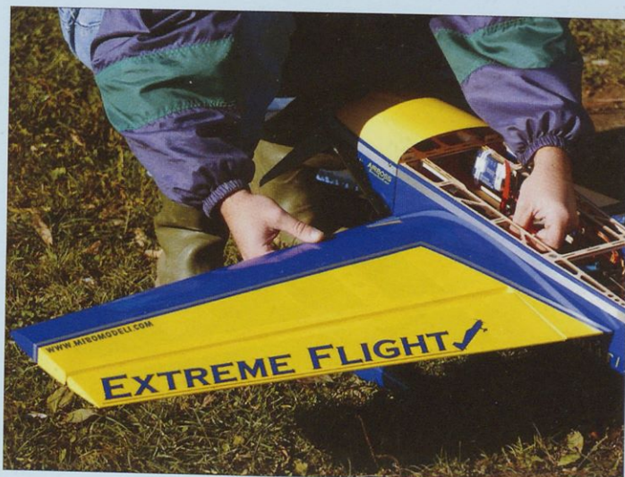
Za sestavljanje kril ne potrebujemo nobenega orodja. Krila se pritrdita na trup s priloženimi plastičnimi vijaki z ušesom.
