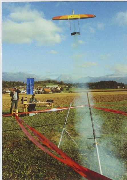
Dvotrupni modeli RV-raketoplanov z V-repom so značilnost t.i. »angleške« šole.
