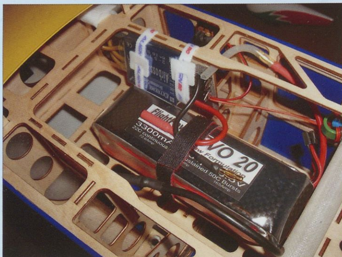
Sprednji del trupa s krmilnikom in pogonskim akumulatorjem. Dobro se vidijo pritrditveni sprijemni trakovi.
