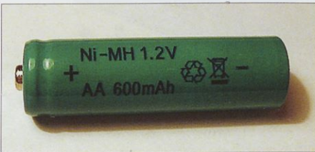
Nakup celic »no-name« odsvetujem. Na plašču celice ni osnovnih podatkov o dovoljenih polnilnih tokovih, niti naziva proizvajalca, pri katerem bi lahko poiskali podatke o lastnostih celice.
