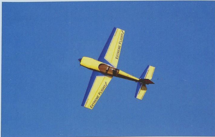
Pri letu na nož je model povsem nevtralen in ne potrebuje nobenih mešalnikov.
