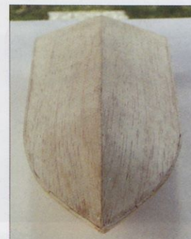
Slika 8. Čoln je prekrit s spodnje strani in se lahko sname z montažne plošče.
