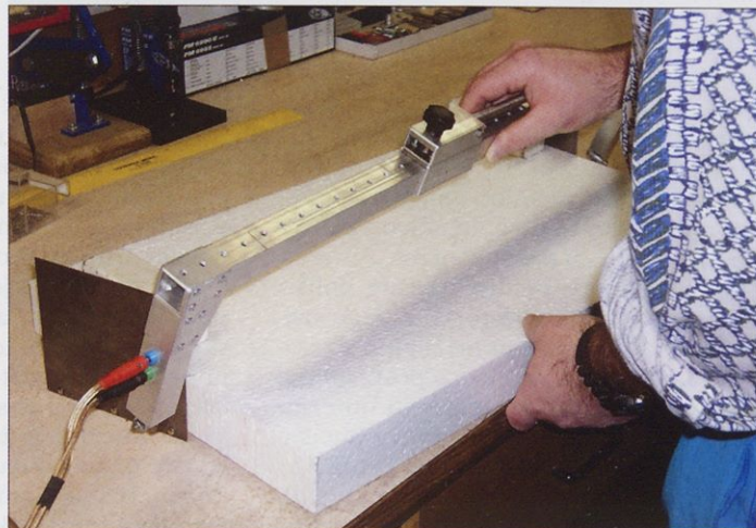
Najprej odrežemo bloke stiropora za krilo, trup in stabilizatorje.
