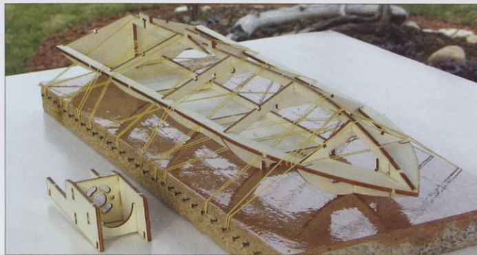
Slika 7. Skelet čolna je dokončan in na vrsti so ojačitve. Nosilec motorja lahko vgradimo pozneje.
