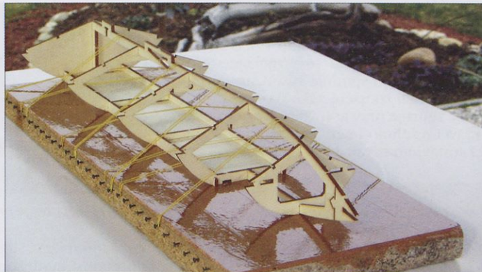
Slika 6. Pri lepljenju si pomagamo z gumicami in bucikami.
