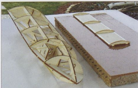
Slika 11. Pokrov prav tako prekrijemo s 3 mm debelo balzo.
