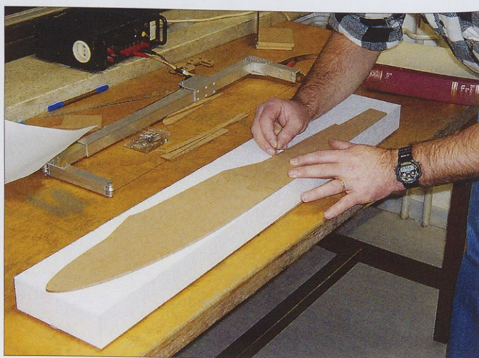
Na blok stiropora z bucikami pritrdimo šablono z obrisom trupa.
