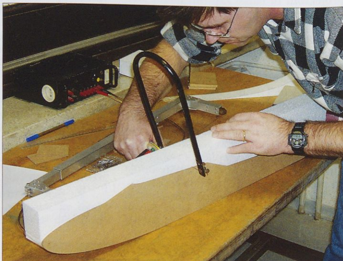
Žago med rezanjem trupa vodimo po obeh šablonah.
