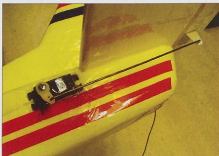
Servomehanizem za višino utrdimo kar z lepilnim trakom.
