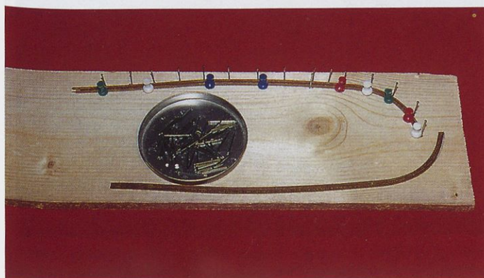
Slika 5. Da bi se vse tri letvice s prerezom 2 \times 2 mm, ki sestavljajo robnik krova povsod tam, kjer ni ograje, popolnoma prilegale njegovim izbočeni obliki, jih zlepite na šablonski deščici. Zadaj je levi robnik med sušenjem, spredaj pa že osušen in obrušen desni robnik.
