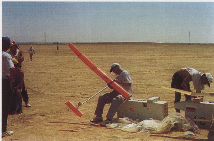
Rus Fuzejev je tekmoval z vzpenjačem z zložljivim krilom. Desna polovica krila je že zložena.
