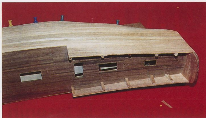
Slika 4. S koščki orehovitih letvic s prerezom 1 \times 5 mm, ki so vam ostali od lepljenja druge oplate, obložite notranjo stran leve in desne ograje ter krmnega dela, prav tako pa tudi robove podaljškove reber, ki gledajo iz palube. Površine nato zgladite s finim brusilnim papirjem.
