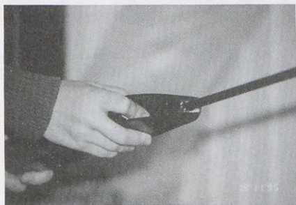
Slika 5. Četrto rebro trupa služi kot opora prstu za boljši prenos sile lučaja modela.
