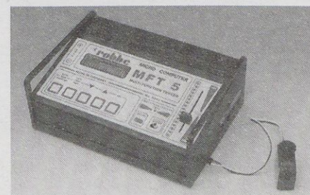
Slika 6. Preizkuševalna naprava za servomehanizme z mikroprocesorjem, Robbejev MFT 535 in servomehanizem C 3321
