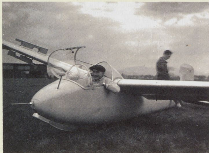
Konstruktor Dušan Cener v kabini udarnika. Dušan Cener je bil tudi priznan jadralni pilot in je z udarnikom opravil drugi let, takoj za Milanom Boriškom. Pitotova cev na nosu letala je bila snemljiva.
