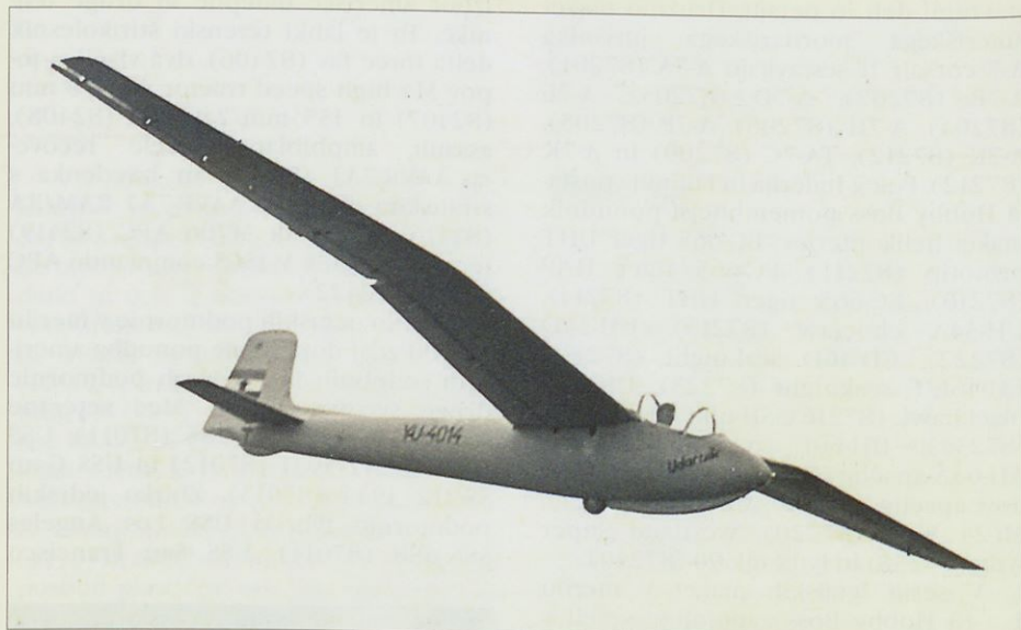
KB-2 udarnik je bil po mnenju mnogih eno od najlepših jadralnih letal tistega časa, po idejni zasnovi pa eno od najnaprednejših. Eleganco udarnika nazorno prikazuje slika letala v letu. Zanimivo je, da so krilca delovala tudi kot pomožna zakrilca.
