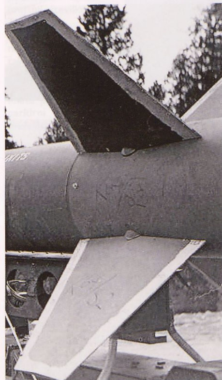
Pritrditev stabilizatorjev prve stopnje
