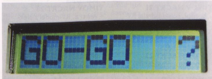
Primer LCD-izbire ukaza. Treba ga je le še potrditi in model lahko štarta, časovnik pa je pripravljen za odštevanje aktiviranja TEV. Čaka le še na vzlet modela, tj. odklop štartnega kabla.
