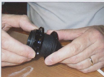
Slika 4. Na navoj privijte vrhnje varovalo.
