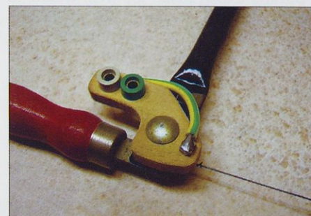
Nosilec električnih vtičnic in način pritrditve na lok rezljače
