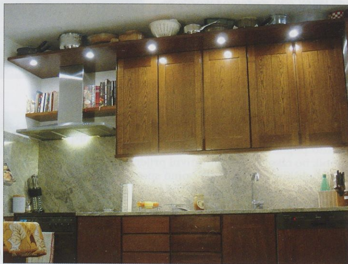
Teh pet žarnic nad kuhinjsko delovno mizo (pultom) se ne prižge tako kot pri sosedih – naenkrat, pač pa druga za drugo z zamikom 250 ms. Zamik je nastavljen s potenciometrom.
