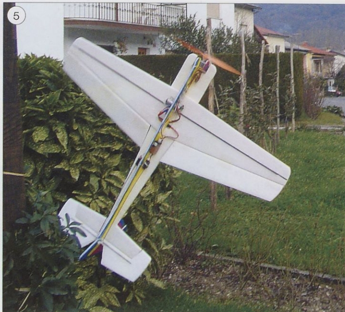
Pogled na komponente, prilepljene na modelu. Krilo iz 6 mm debelega deprona nima profila.
