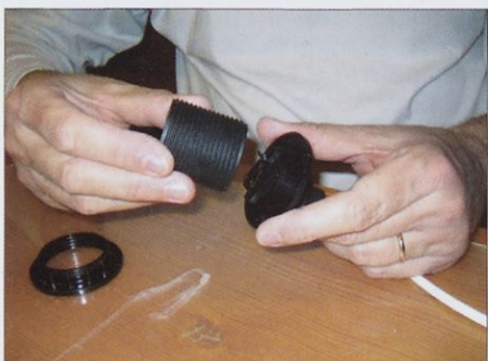
Slika 3. Dodajte nosilec žarnice z navojem.
