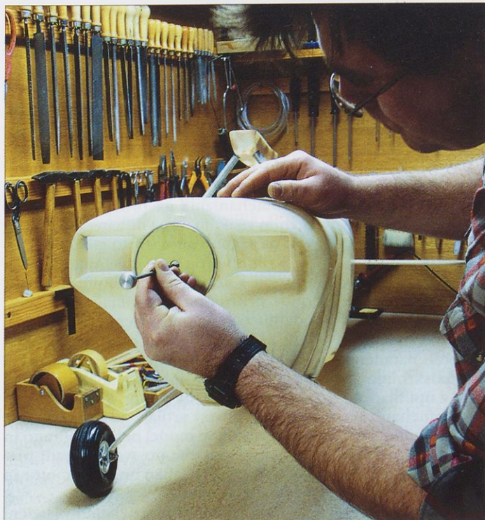
Podnožje kape propelerja, ki ga z lepilnim trakom pritrdimo na svoje mesto, določa os, ki jo mora doseči motor.
