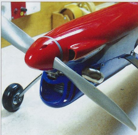
Model F3A, na katerem je bila požarna stena motorja že vlepljena pod ustreznimi koti.
