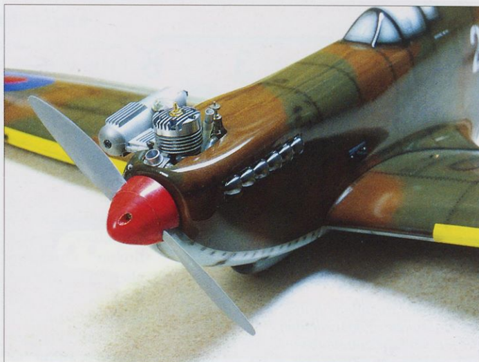
Primer modela, brez snemljivega pokrova motorja. S pomočjo centrirne igle je bila montaža motorja lažja, natančnejša in hitrejša.
