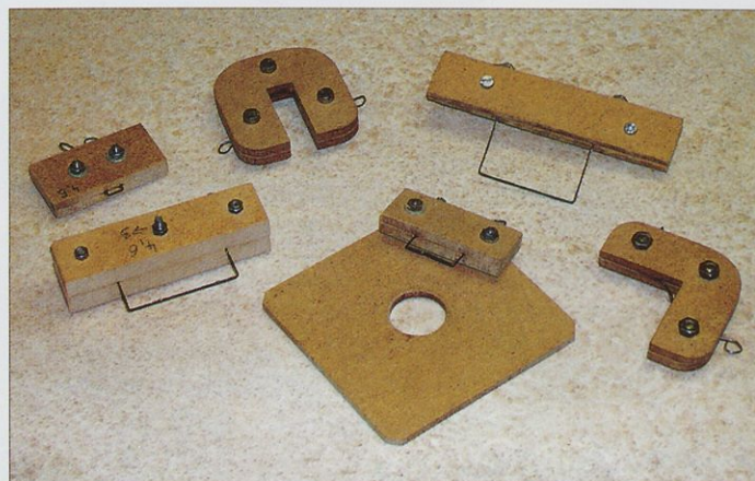
Priprave za rezanje utorov. Šablona na sredini je namenjena za rezanje okroglega utora na višinskem krmilu.
