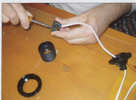
Slika 2. V nosilec žarnice pritrdite električno žico.
