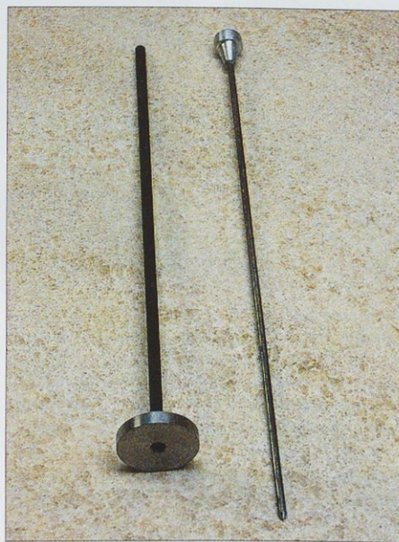
Centrirna igla je sestavljena iz notranje igle in zunanega nastavka.
