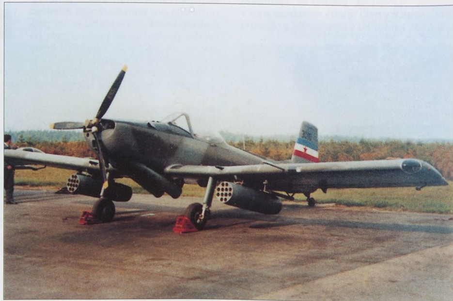
J-20 kragulj na ploščadi vojaškega dela letališča Brnik. Pod krili ima nosilca za 24 nevo-de-nih izstrelkov kalibra 57 mm.
