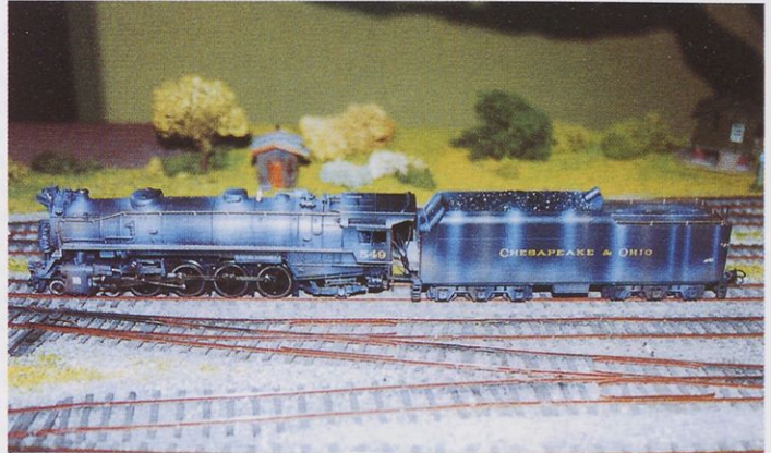
Model ameriške parne lokomotive J-2 4-8-2 Mountain družbe Chesapeake & Ohio je namenjen digitalnemu sistemu vodenja DC in AC ter ima vgrajen loksound zvočni dekodler.
