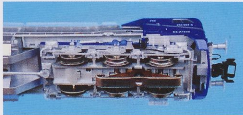
Drsnik na modelu lokomotive Modri Tiger, ki je namenjena za AC-vodenje. Mehano skoraj vse svoje lokomotive iz hobijskega programa opremlja tudi za AC-vodenje.
