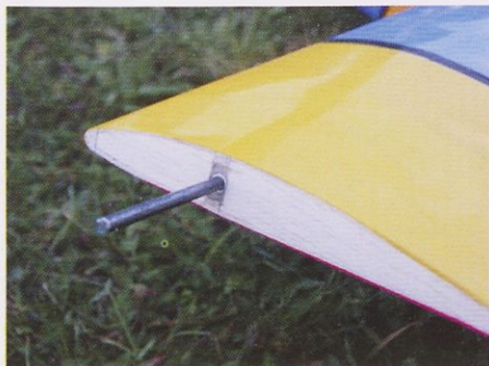
Da je model lažji za prevoz, lahko krilo izdelamo v dveh delih, ki ju spojimo s 4-mm jeklenim bajonetom.
