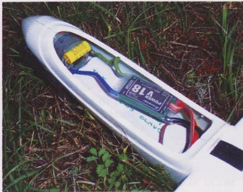
Vse tri različice modela z odstranjeno kabino. Lepo se vidi notranja razporeditev komponent in, kjer je potrebno, dodatna obtežitev.
