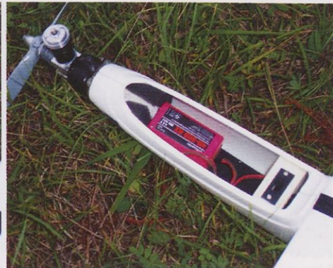
Vse tri različice modela z odstranjeno kabino. Lepo se vidi notranja razporeditev komponent in, kjer je potrebno, dodatna obtežitev.
