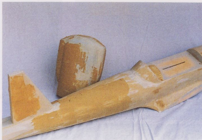
Trup letalskega modela, grobo obdelan s poliestrskim kitom
