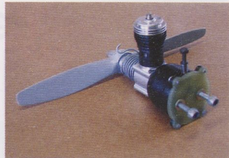
Motorček Cox je v modelu pritrjen na rebro iz 2-mm vitroplasta, ki je na sprednji del trupa privito z vgreznimi vijaki.
