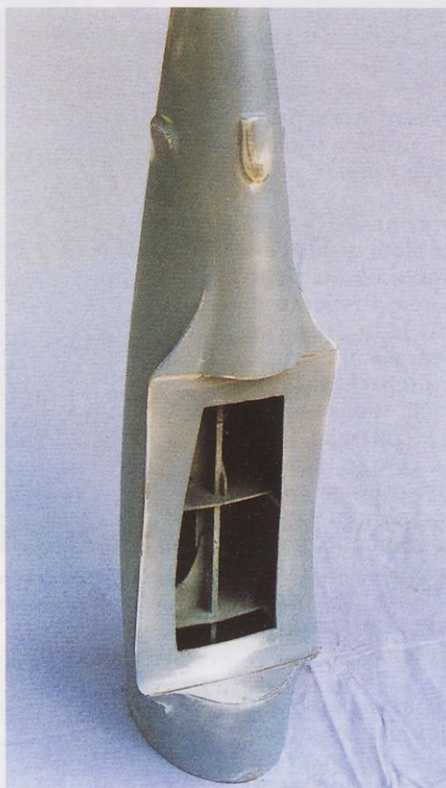
Dobro je vidna lesena konstrukcija pramodela in osrednji nosilec v T obliki, na katerega so nanizana rebra.
