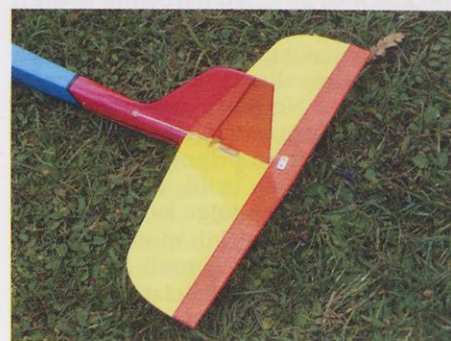
S preprostim trikom predelamo višinski stabilizator tako, da je snemljiv, kar precej olajša rokovanje z modelom.
