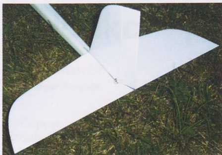
Na repu so uporabljeni najlonski šarnirji, ki jih v že končan rep prilepimo z redkim sekundnim lepilom.
