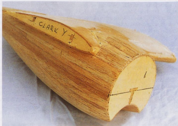
Nosilec motorja letalskega modela in izdelava pramodela na način prekrivanja z balzovimi trakovi
