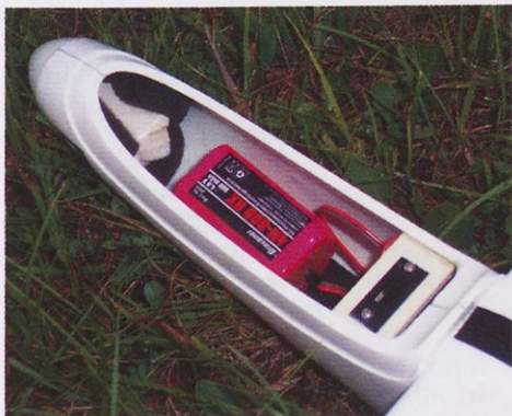
Vse tri različice modela z odstranjeno kabino. Lepo se vidi notranja razporeditev komponent in, kjer je potrebno, dodatna obtežitev.
