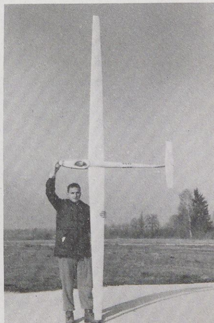
13: Lepotec, »super orhideja« CALIF (proizvajalec GEITNER GFK Flugmodellbau, Avstrija) je izdelan v kalupu v sodobni tehnologiji in v celoti iz kompozitnih vlaken. Z razpetino 4 m in z vitkostjo kril 24 ter vrsto dodatnih vgra
