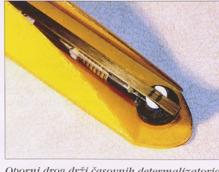
Oporni drog drži časovnik detormalizatorja v izključenem položaju.
