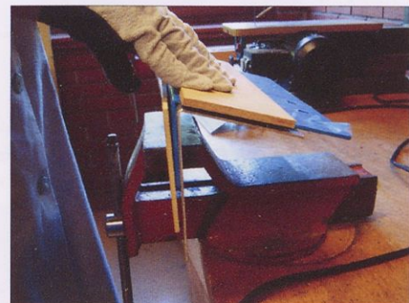
Slika 7. Zmehčano plastiko upognemo brez težav.
