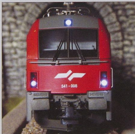
Pri modelih DC brez dekodirnika svetijo v žarometih samo kratke luči sorazmerno s hitrostjo. Pri modelih z dekodirnikom v digitalnem sistemu napajanja svetijo žarometi konstantno tako med vožnjo kot v mirovanju.
