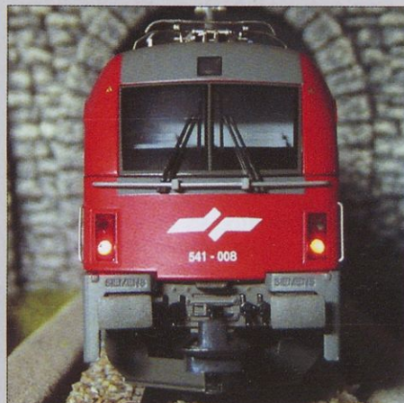
Pri menjavi smeri vožnje na zadnji strani lokomotive zasvetijo rdeči žarometi, ki pri modelih z dekodirnikom in pri digitalnem napajanju konstantno svetijo med vožnjo in v mirovanju.
