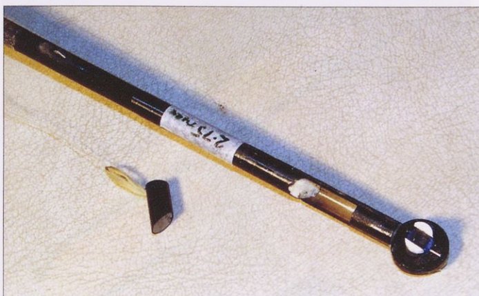
Determalizator z ločljivim balastom, ki poruši ravnovesje jadrajčega dela modela.
