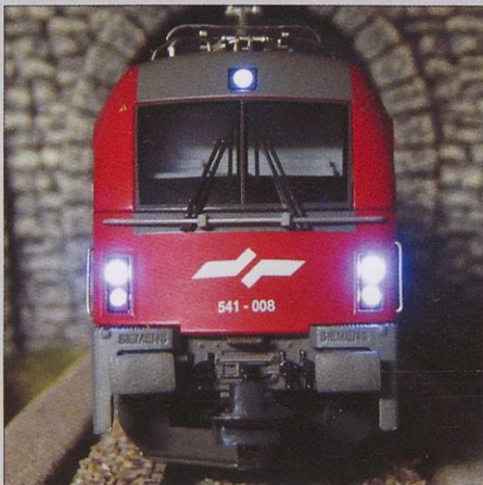
Samo pri modelih z dekodirnikom in pri digitalnem napajanju svetijo žarometi tudi z dolgimi lučmi, kjer je svetlobni snop močnejši kot pri kratkih lučeh.
