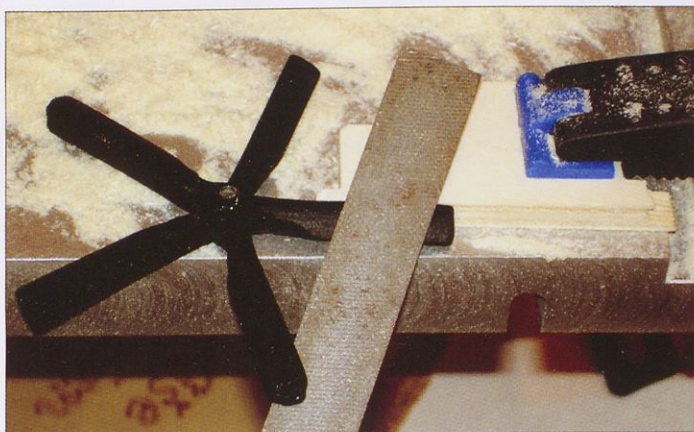
Krak repnega rotorja je prav tako trikotne oblike. Med obdelovanjem ga prislonimo ob odsluženi kos vezane plošče, sicer se lahko kaj odlomi.
