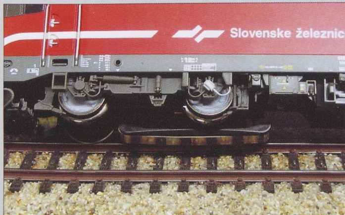
Modeli, namenjeni sistemu AC, imajo na enem podstavnem vozičku vgrajen sodobnejši raven drsnik za napajanje modela.
