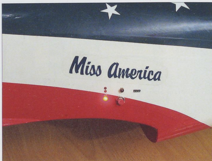
Prikaz indikatorja napetosti celice na boku modela ob nepriključenju celici ali izpraznjeni celici (napetost \leq 1,0 V)
