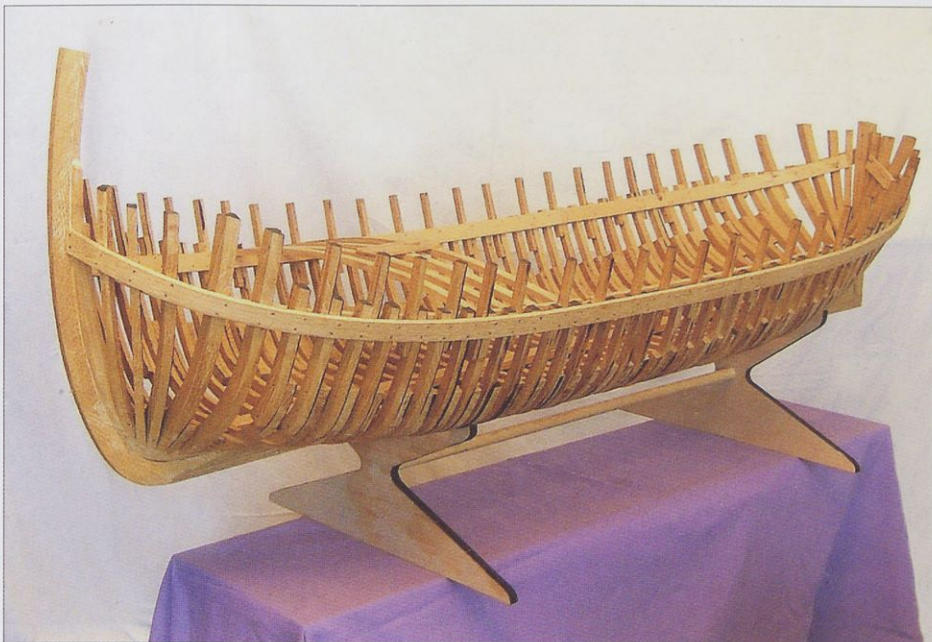
Vrhunske makete so pravzaprav v vseh podrobnostih pomanjšana prava plovila. Na fotografiji vidimo 135 cm dolgo hrastovo ogrodje nastajajoče makete istrske bracer v merilu 1 : 10. Bracera je bila zgrajena v začetku 20. stoletja v piranskem škveru. Takí modeli nastajajo predvsem na temelju originalnih načrtov.
