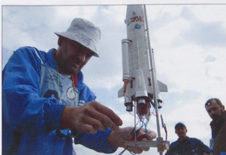
Vladimir Čipčić iz Kikinde namešča električne vžigalnike v motorje makete rakete ariane 3.
