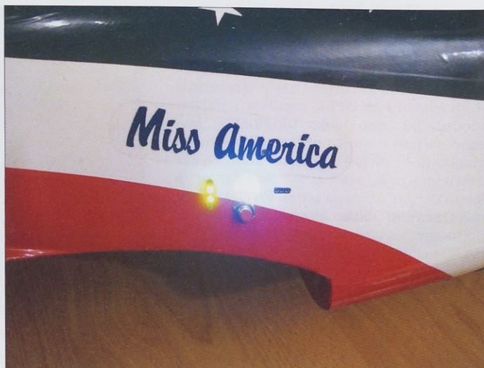
Prikaz indikatorja napetosti celice ob delovanju regulatorja (prikazana napetost je med 1,1 in 1,2 V)
