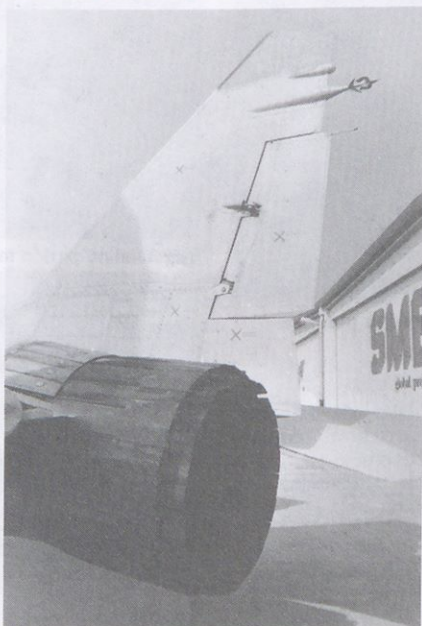
Desna polovica repa s smernim krmilom in senzorji ter izpuh motorja z razprtimi lopaticami
