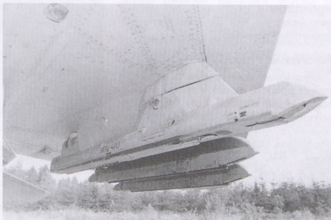
Detajl nosilca za rakete zrak-zrak R-27/ A-10 alamo
