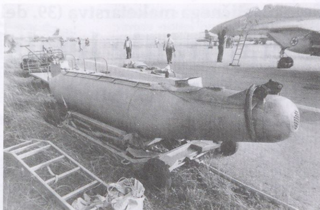
Dodatni rezervoar za gorivo z značilnim jaškom za odvod plinov na desni strani
