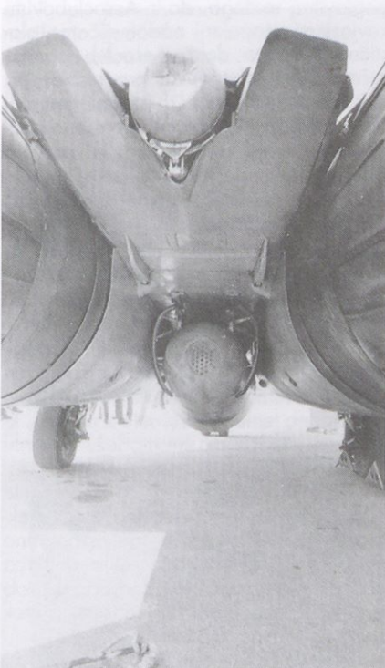
Zaprta zračna zavora s kapo na cevastem skladišču za zaviralno padalo. Na rezervoarju za gorivo so vidni varovalni obroči.
