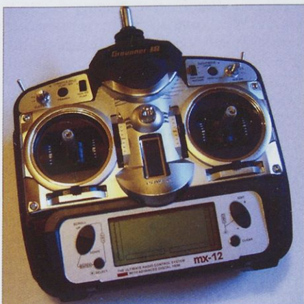
Za programiranje MX12 so namenjeni štirje gumbi.
