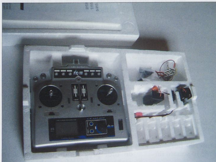
Vsebina kompleta FX18 brez treh standardnih servomehanizmov S3001
