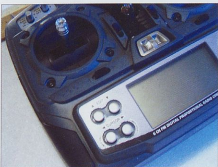
Programiranje pri optic 6 poteka s pomočjo osmih gumbov.
