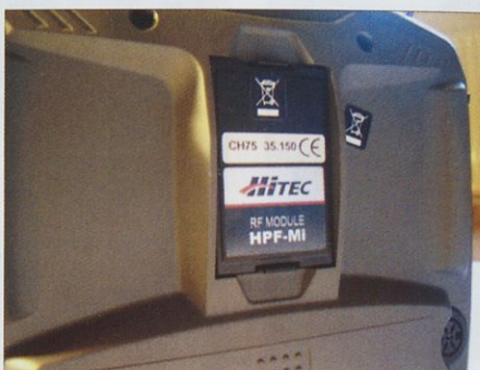
Izmenljivi modul pri Hitecovi napravi
