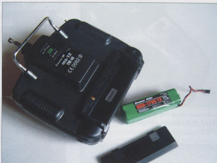
Priloženi akumulatorji MX12 imajo kapaciteto 1700 mAh.
