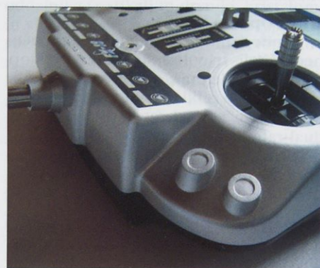
Futabina naprava ima štiri prosta mesta za vgradnjo drsnikov in deset za vgradnjo stikal.
