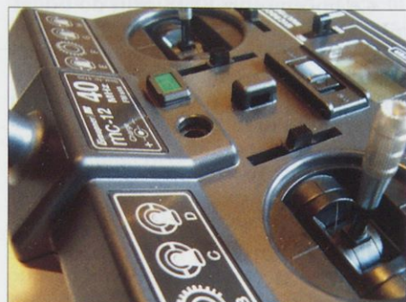
V kompletu MC12 ni priloženih stikal ali drsnikov. Treba jih je dokupiti ali narediti.
