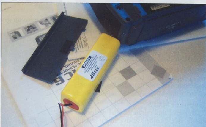
Optic 6 ima priložen akumulatorski paket s kapaciteto samo 600 mAh.
