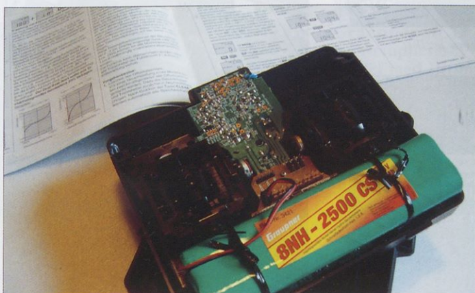
Akumulatorji pri MC12 imajo kapaciteto kar 2500 mAh.
