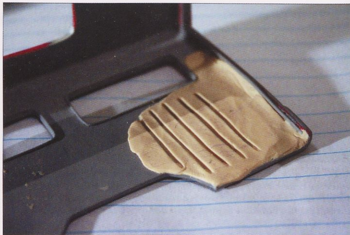
Slika 13. Del notranjosti kabine je poskusno odet v maso FIMO z nakazanimi reliefnimi zarezi.
