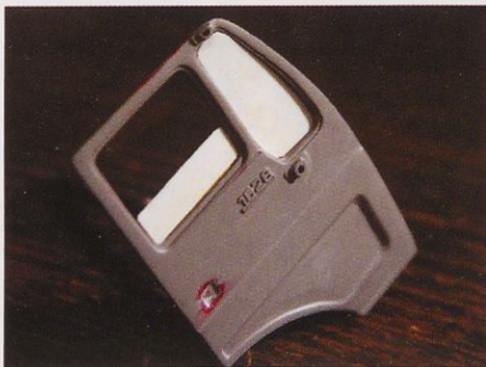
Slika 3. Vrata z vstavljenimi na novo izdelanimi stekli, ki so tu nalašč bele barve, da se lepše vidijo na fotografijah. Večje kvadratno steklo je v položaju, kot da je spuščeno. S tem preprostim trikom je maketa videti zanimivejša.
