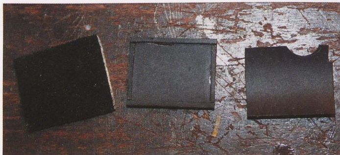
Slika 5. Na desni se vidi osnova za talno oblogo, narejena iz termoskrčljive cevke. Polkrožni izrez na vrhu je narejen zaradi volanskega mehanizma. Na sredini je osnova talne obloge z že narejenim robom, na levi pa kos žametne tapete, ki ga bomo prilepili v sredino.
