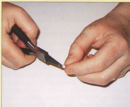
Slika 3. Zvijanje žice v zanko na enem koncu žice
