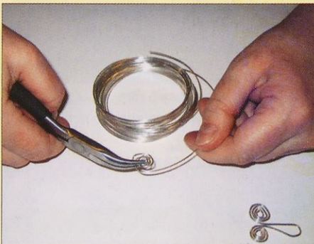
Slika 5. Izdelava spiralnega žičnega okrasa
