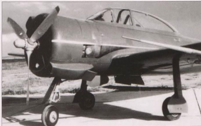
Detajl sprednjega dela triana. Pod levim krilom je izrazita sonda za meritve, ki je bila nameščena le kratek čas.
