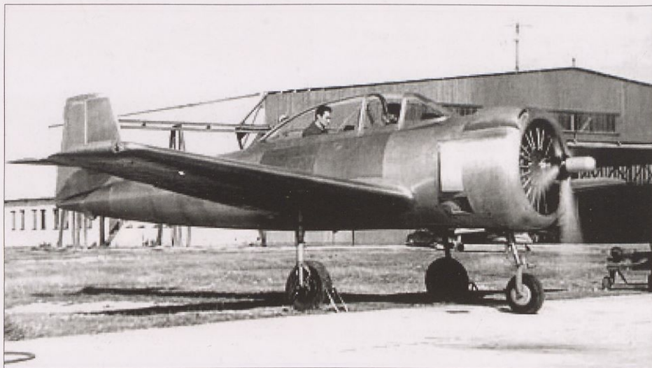
Preizkus motorja pri prvem prototipu triana na tovarniškem letališču podjetja Hispano. Letalo je nepobarvano in brez oznak.
