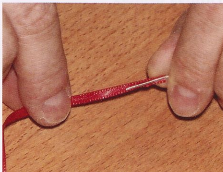
Slika 4. Lepljenje konca tekstilnega traku na žico pred začetkom ovijanja
