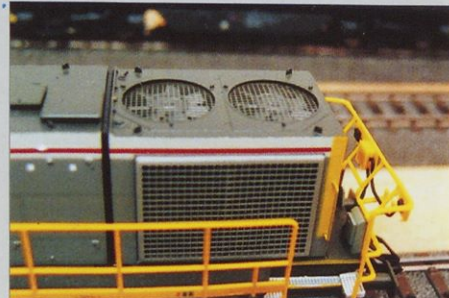
Rešetke na hladilniku in nad ventilatorjema so jedkane iz alpeke po fotopostopku.
