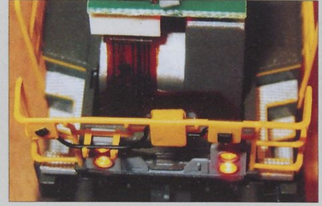
Svetleče diode so pritrjene na folijo.
