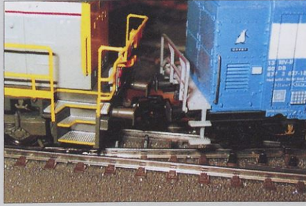
Ker spenjače nimajo kulisnega mehanizma, sta se odbijača lokomotive in vagona v ostrih zavojih tesno dotikala, vendar ni bilo težav z vleko ali potiskanjem vagonov.
