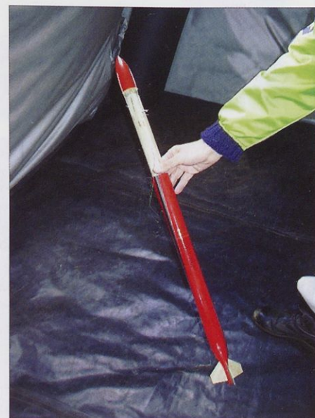
Rotor z zloženimi kraki med vstavljanjem v trup modela
