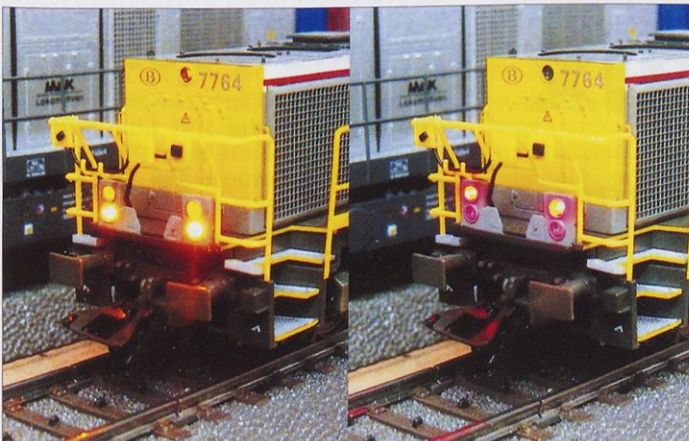
Žarometi so spredaj svetlorumeni in zadaj rdeči, delovanje pa je odvisno od smeri vožnje modela.
