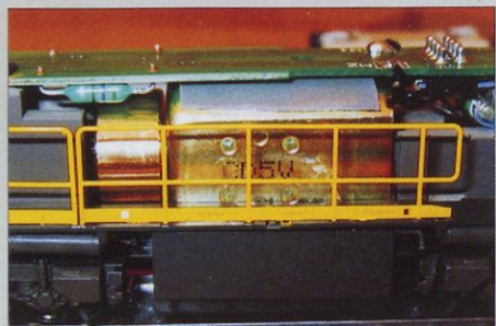
Model prek kardanskih gredi in polžastih ter zobniških prenosov poganja centralno nameščen sodobni petpolni motor.
