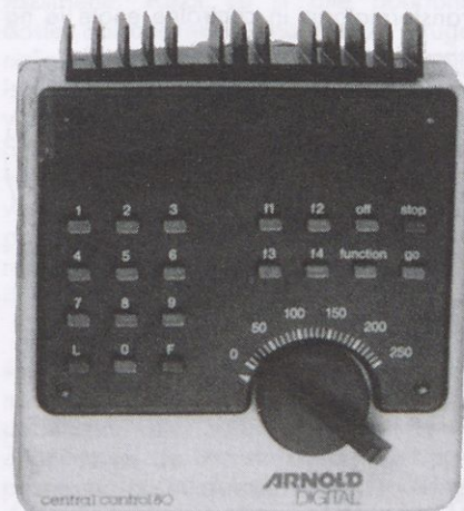
Centralna enota Arnold digital, ki hkrati služi tudi za upravljanje vožnje 99 lokomotiv
