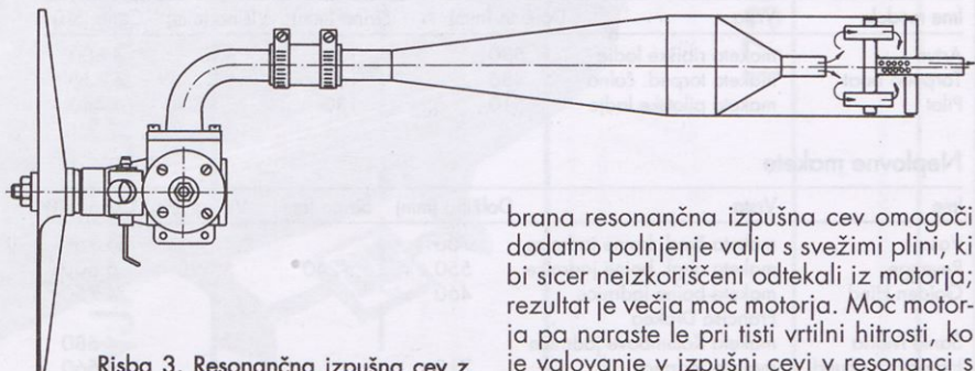
Risba 3. Resonančna izpušna cev z dušilecem hrupa
