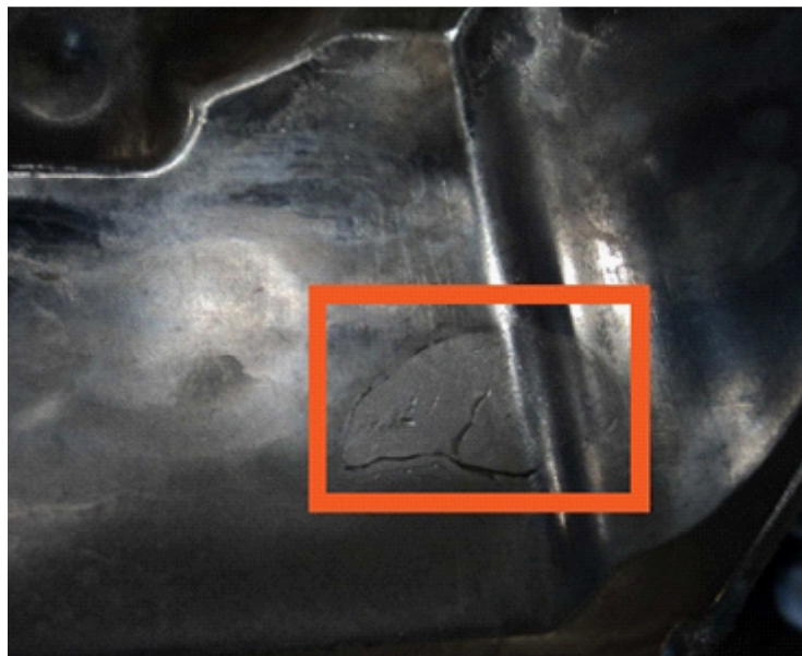
Slika 3: Hladni zvar pri klasični konstrukciji zračenja
