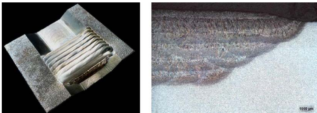
Slika 6: Poskus navarjanja v izbrušeni globeli (levo) in ustrezen prerez poliranega prereza navara (desno)
