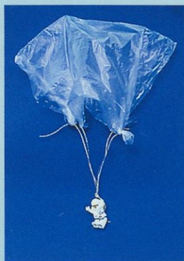
Da je hitrost padanja enako velikih in enako oblikovanih teles odvisna le od mase telesa, lahko preverimo s spuščanjem istega padalca, ki ga različno obtežimo.
