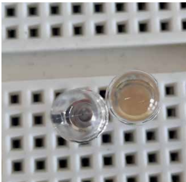
Slika 4: Različne LED – leva je primerna za izvedbo eksperimenta, desna pa izkorišča fosforescenco in izhodna svetloba ni neposredno povezana z velikostjo energijske reže.
