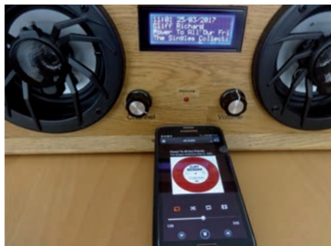
△ Digitalni radijski sprejemnik v ličnem lesenem ohišju domače izdelave z vgrajenimi zvočniki in ojačevalnikom ter daljinskim upravljanjem.
