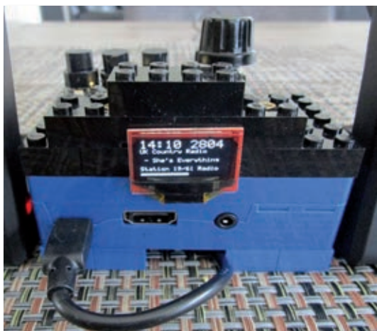
△ Digitalni radijski sprejemnik v ohišju LEGO z zunanjim ojačevalnikom in zvočniki.
