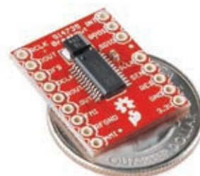
△ Kot kovanec za četrta dolarjev velik digitalni enočipni valovni radijski sprejemnik Si4735 na vgradnem tiskanem vezju.
