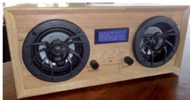
△ Digitalni radijski sprejemnik v ličnem lesenem ohišju domače izdelave z vgrajenimi zvočniki in ojačevalnikom ter daljinskim upravljanjem.
