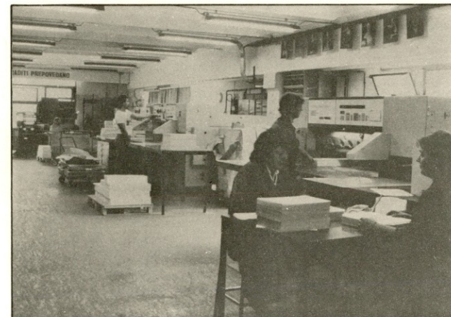
Oddelek knjigoveznica v katerem so stroji za razrez papirja, perforirni in šivalni stroji ter ročna dodelava izdelkov
