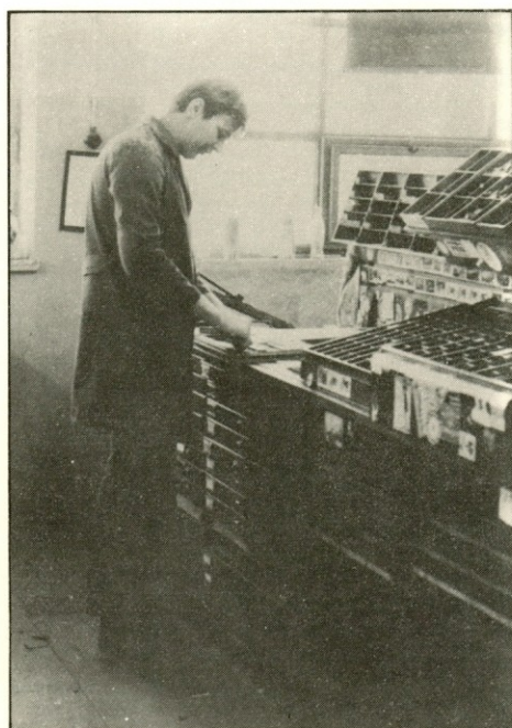
Oddelek ročne stavnice, kjer se vrši prelom časopisne strani, ki je opremljena s strojnimi stavkami naslovnimi črkami in slikami
