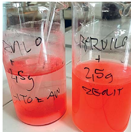
Slika 4: Odpadni vodi, onesnaženi z barvilom po čiščenju s hitozanom (levo) in z zeolitom (desno) v koncentraciji 12,5 g/l
