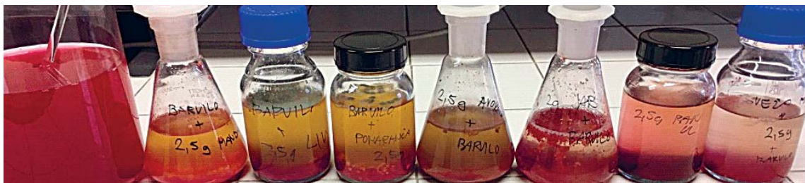
Slika 3: Od leve proti desni: izhodiščno onesnažena odpadna voda z barvilom, odpadne vode, očiščene z mandarininimi, limoninimi, pomarančnimi, avokadovimi, jabolčnimi in bananinimi olupki in z nesušeno (svežo) banano
