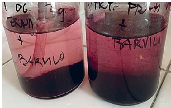
Slika 6: Odpadni vodi, onesnaženi z barvilom po čiščenju z 10 g/l aktivnega oglja v granulah (GAC) in z 2,5 g/l aktivnega oglja v prahu (PAC)
