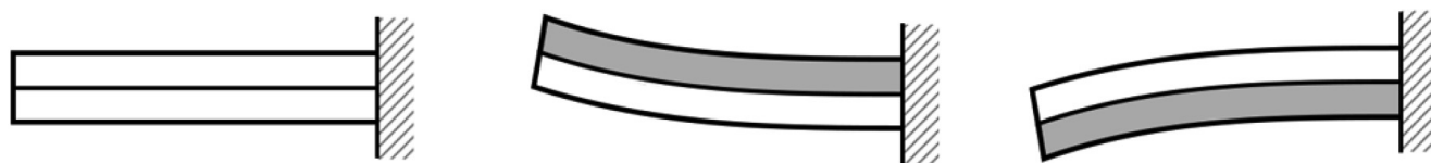
Slika 1: Piezoelektrični pretvornik v nevzbujenem stanju in obeh vzbujenih stanjih. Siva barva pomeni del PZT, ki je pod električno napetostjo. V tem primeru se ta del skrči.
