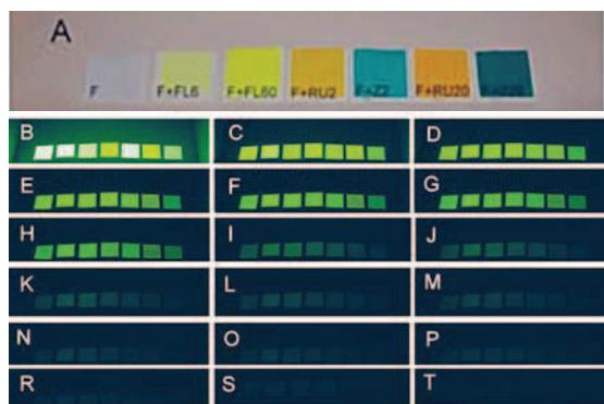
Slika 4: Fotografije svetlobne aktivnosti vzorcev, potiskanih s fosforecenčnimi pigmenti in z mešanicami z navadnimi barvnimi pigmenti, posnete pri dnevni svetlobi (A), v temi po desetminutnem osvetljevanju v svetlobni komori (B–T) po 0 s (B), 10 s (C), 20 s (D), 30 s (E), 40 s (F), 50 s (G), 60 s (H), 120 s (I), 180 s (J), 240 s (K), 300 s (L), 360 s (M), 420 s (N), 480 s (O), 540 s (P), 600 s (R), 1200 s (S) in 1800 s (T) po prekinitvi svetlobnega vira
