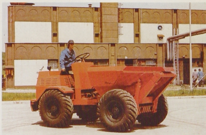
Damper D-2000 H za dela v gradbeništvu, primeren za težke terene, izdelujejo v več izvedbah. Največ ga izvažajo v države v razvoju.
