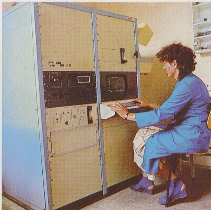
Sodoben kvantomer za redne preglede surovin, polizdelkov in gotovih izdelkov za ugotavljanje kemijskih, mehanskih, metalografskih in dimenzijskih preiskav za izdajo sestavnih atestov.
