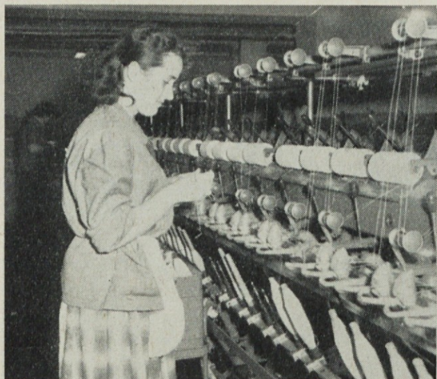
Novi dvojni stroj SAVIO omogoča večjo produkcijo dvojnice
